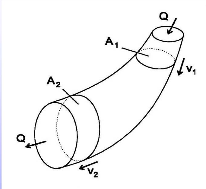
Fluss durch eine Stromröhre
